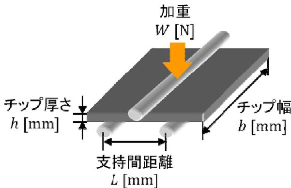
Fig. 2 三点曲げ抗折強度測定
